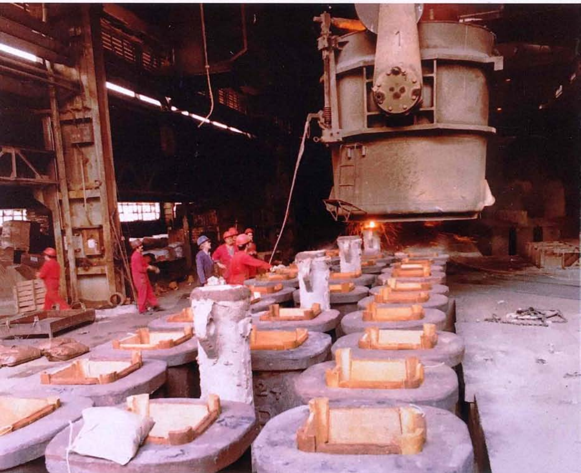
PREPARANDO LA COLADA
